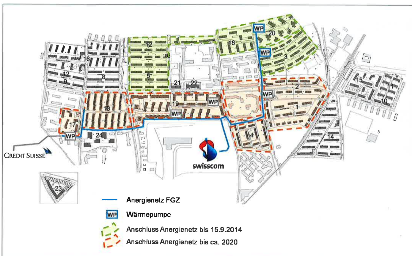
Das Anergienetz wird schrittweise erweitert, um die Energieversorgung der FGZ mit Abwärme und Erdwärmespeicher versorgen zu können. (Bild: Amstein + Walthert AG)
